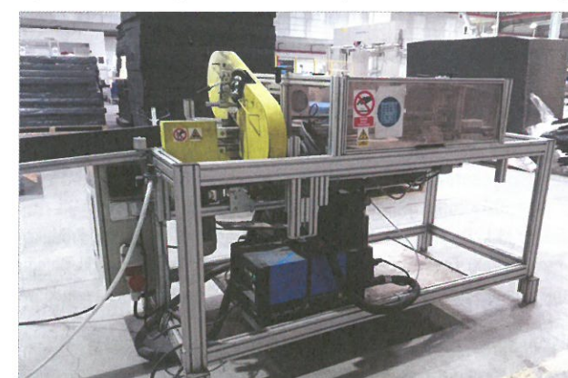
Rys. 5. Urządzenie do produkcji uszczelnień klinowych z dotychczasowych odpadów produkcyjnych Fot.: Interchemall Sp. z o.o.
