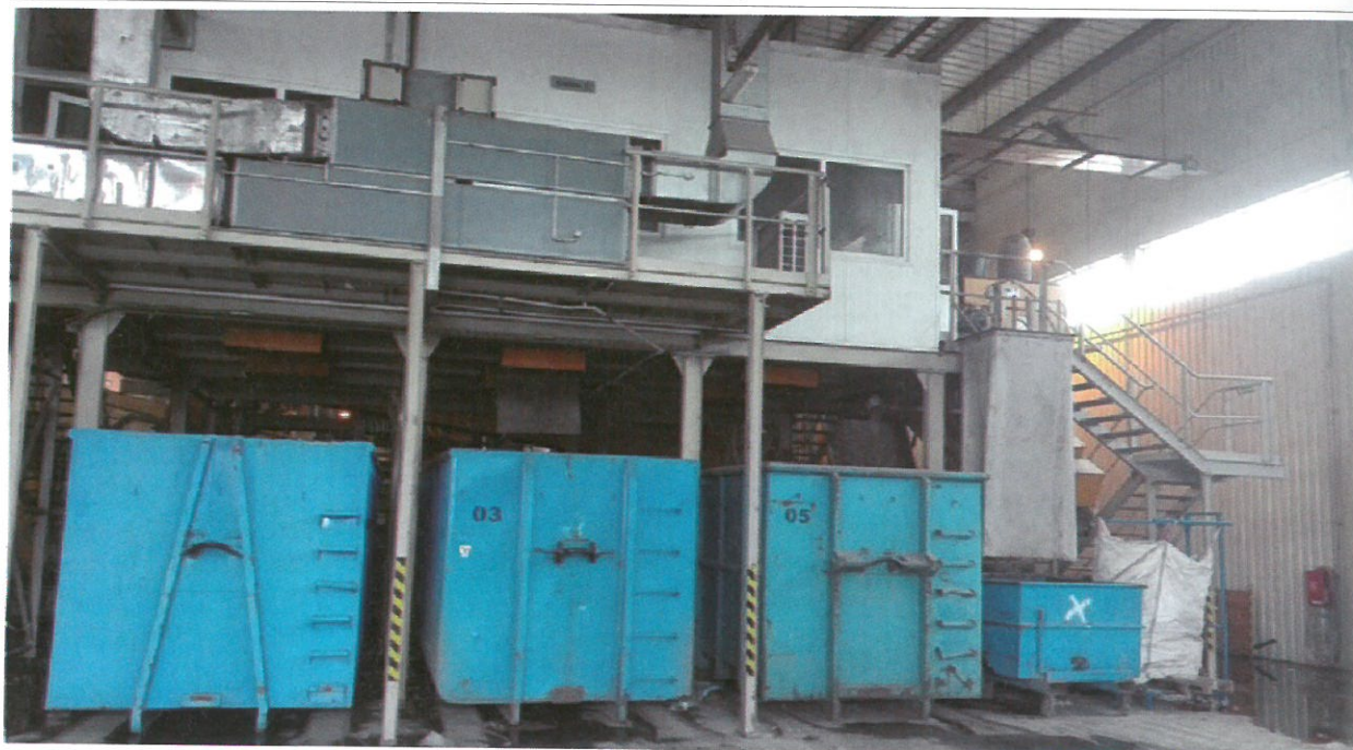
Fot. 2. Kontenery pod kabiną wstępnego sortowania (do tymczasowego magazynowania odpadów szła, drewna itp.) w ZUOK-u „Orli Staw”
