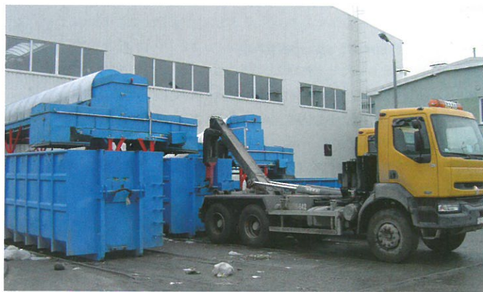
Do transportu odpadów powszechnie stosuje się samochody z zabudową hakową
