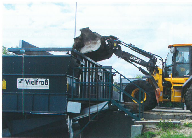
► Ładowarka z wbudowaną wagą umożliwia biogazowni Chabičovice ciągłe ważenie poszczególnych substratów
