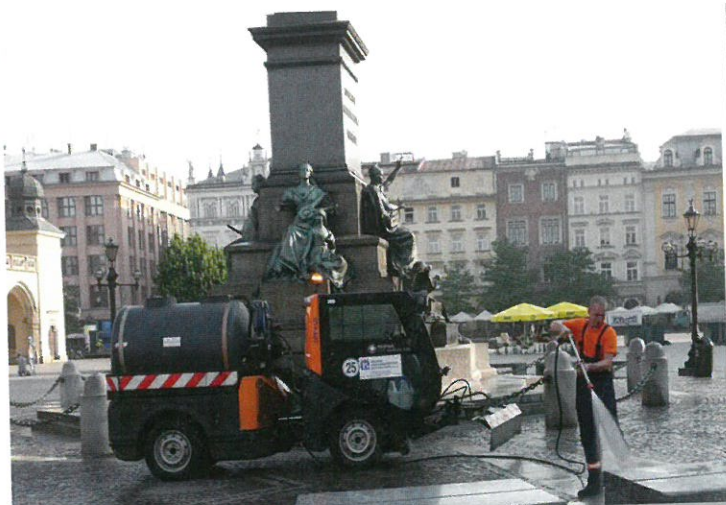
Fot. 1. Mała polewaczka pracująca na krakowskim Rynku, której wymiary pozwalają na poruszanie się po wąskich uliczkach miasta
