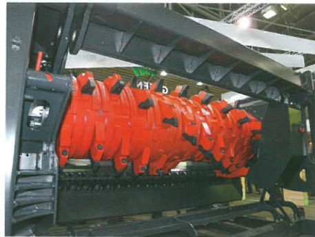
W Terminatorze Type V zwiększono liczbę zębów rotora oraz ich wysokość. Było to konieczne w celu zapewnienia odpowiedniej wydajności i jakości materiału wyjściowego podczas pracy z odpadami drzewnymi.
