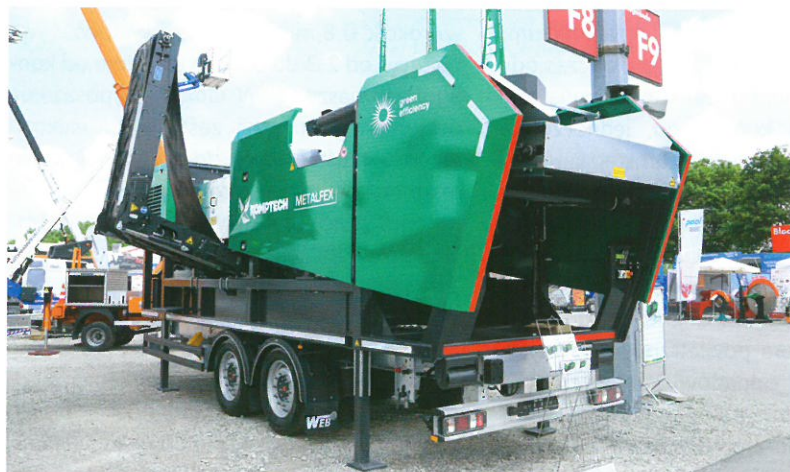
Separator Metalfex może wydzielać zarówno materiały nieżelazne, jak i żelazne. Jest oferowany na ramie podhakowej lub jako przyczepa 2-osiowa.
