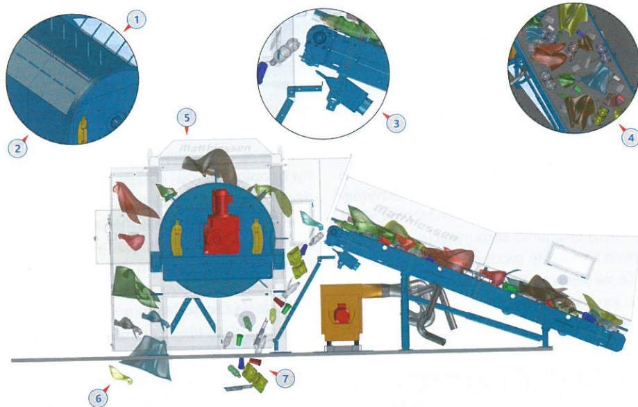
Schemat działania urządzenia Matthiessen do separacji frakcji lekkiej. 1), 2) obrotowy bęben z chowanymi kolcami przechwytyjącymi odseparowane materiały lekkie, 3) dysza pneumatyczna, 4) strumień odpadów zmieszanych, 5) komora robocza, 6) odseparowana frakcja lekka, 7) frakcja ciężka.
