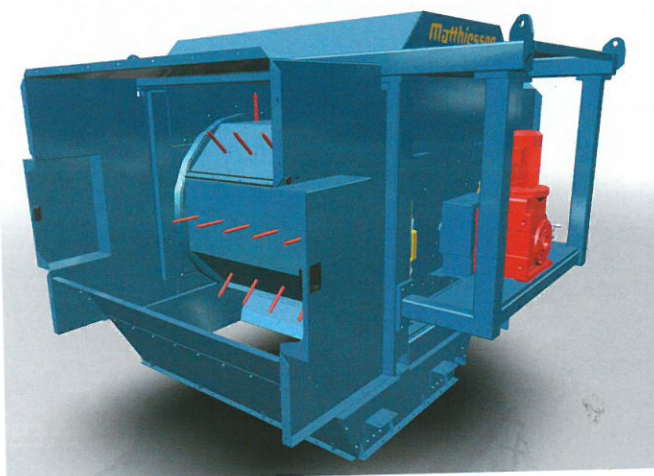
Schemat działania urządzenia Matthiessen do separacji frakcji lekkiej. 1), 2) obrotowy bęben z chowanymi kolcami przechwytyjącymi odseparowane materiały lekkie, 3) dysza pneumatyczna, 4) strumień odpadów zmieszanych, 5) komora robocza, 6) odseparowana frakcja lekka, 7) frakcja ciężka.
