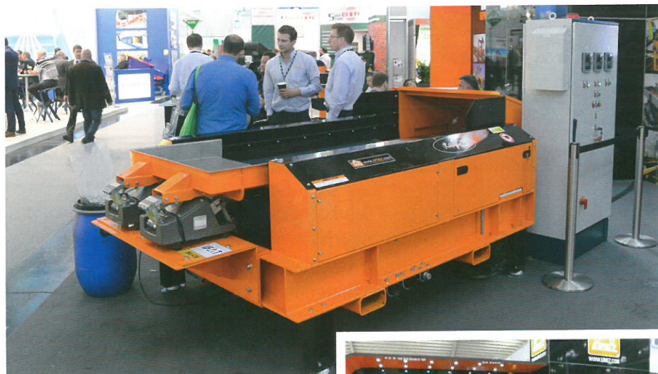
W swoich najnowszych rozwiązaniach Eriez skupia się na tworzeniu bloków magnesów wielobiegunowych o wyższym gradiencie w połączeniu z bardziej kompaktowymi rozmiarami kompletnych urządzeń, a także usprawnieniu układów samoczyszczących. U góry separator RevX-E ST Eddy, u dołu – magnes nadtaśmowy TPI.
