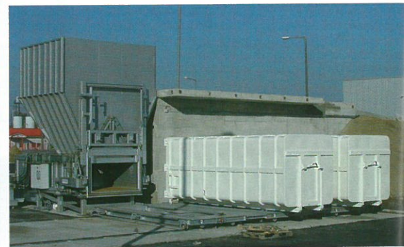
Dzięki stacjom przeładunkowym odpady mogą być efektywnie transportowane na większe odległości. Firma Husmann oferuje pojedyncze elementy takich instalacji, jak też zapewnia kompleksowe rozwiązania „pod klucz”.
