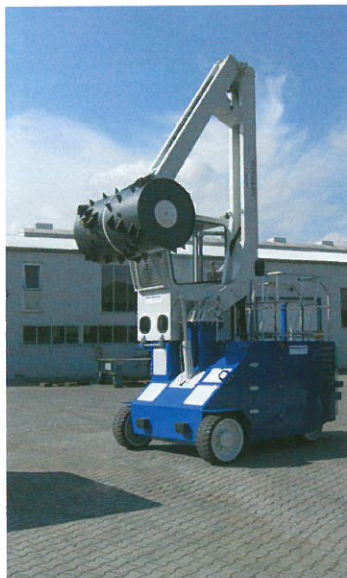
Roll-packery pozwalają na skuteczne zagęszczanie odpadów w najczęściej spotykanych kontenerach otwartych. Kluczowym elementem każdej takiej maszyny jest stalowy walec, który łamie i ugniata materiały zgromadzone w pojemniku.
