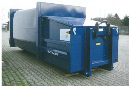
Prasy stacjonarne mogą współpracować z wymiennymi kontenerami dla wszystkich stosowanych systemów wywozu odpadów. Na zdjęciu urządzenie z zasypem przy ścianie obiektu.
