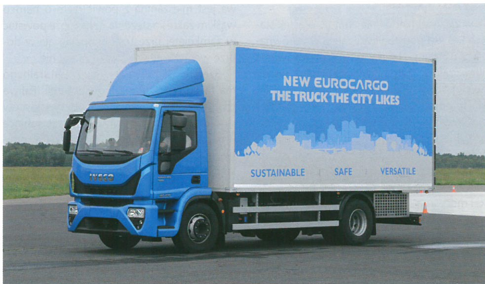
Gazowy Eurocargo o DMC 16 t może być pojazdem dystrybucyjnym obsługującym strefy, do których nie są wpuszczane diesle. Zmodernizowany silnik Cursor 6 NP jest trwały, niezawodny i oszczędnie zużywa sprężony gaz.
