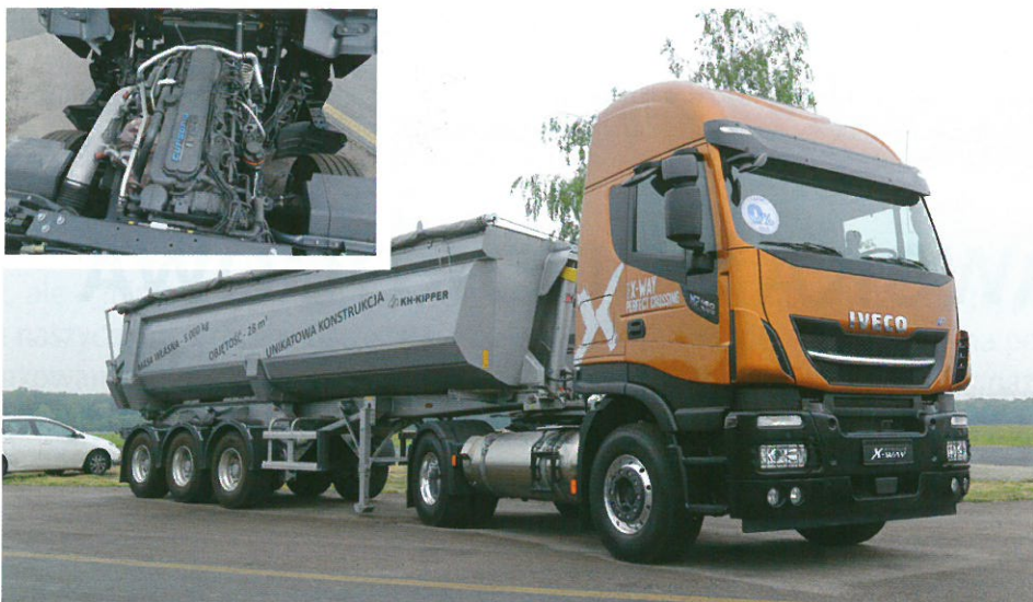
Nowy silnik Iveco Cursor 13 NP zaprojektowano z myślą o długodystansowym transporcie, ale można go również zamówić do Stralisy X-Way – wersji przystosowanej do transportu budowlanego lub komunalnego (np. przewóz odpadów ze stacji przeładunkowej do sortowni). Usprawniony proces spalania zapewnia możliwie najniższe zużycie paliwa na długich trasach. Wtryskiwacz gazu o dużej przepustowości, szynę paliwową, tłoki i turbosprężarkę zaprojektowano w sposób umożliwiający uzyskanie wysokiej mocy i momentu obrotowego.
