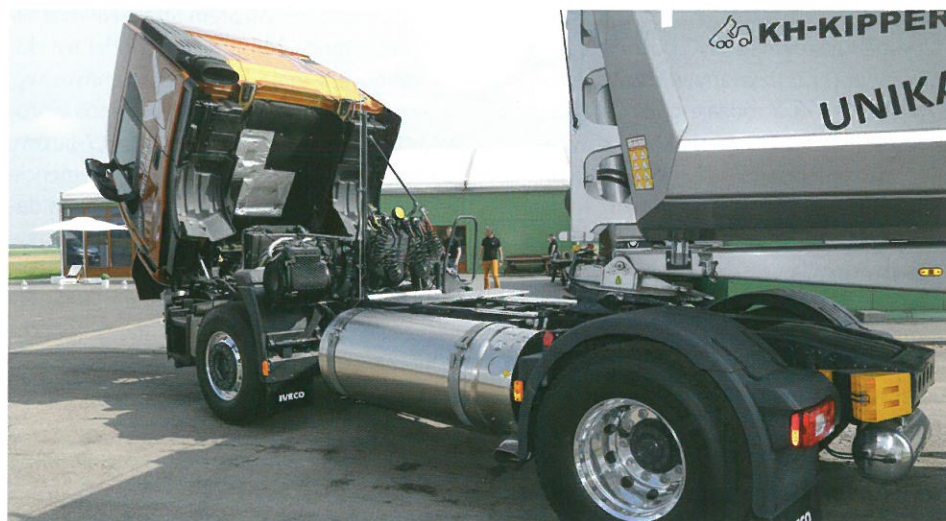
Schłodzony do temperatury -167°C gaz ziemny ulega skropleniu, zmniejszając swoją objętość 600-krotnie. Taki stan skupienia wymaga zastosowania zbiorników kriogenicznych, które zapewniają odpowiednią izolację cieplną.
