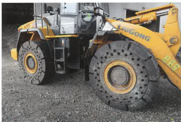
Ładowarkę wyposażono w opony lite MAGNA MA601. W przypadku opon pneumatycznych nawet klasy L5 takie nacięcia mogłyby spowodować czasowe wyłączenie maszyny z ruchu.
