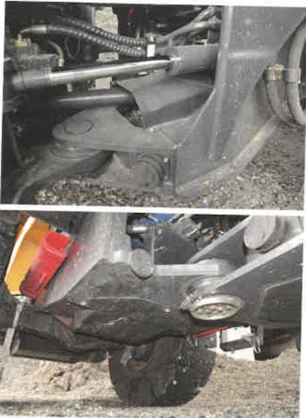
Maszyna została wyposażona w dodatkowe osłony podwozia i przegubu, które chronią przed wnikaniem kłopotliwych odpadów, np. w postaci sznurków czy drutów.
