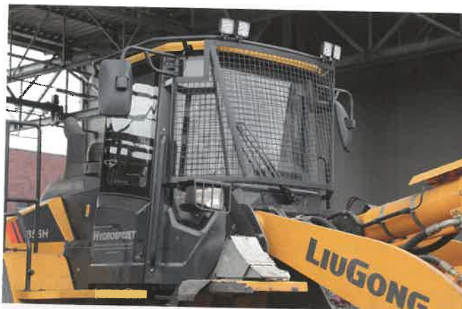
Przy wysokim operowaniu ładunkiem zawsze może coś wypaść z tyłki. Aby nie doszło do stłuczenia szyby i reflektorów, elementy te zostały zabezpieczone osłonami siatkowymi.
